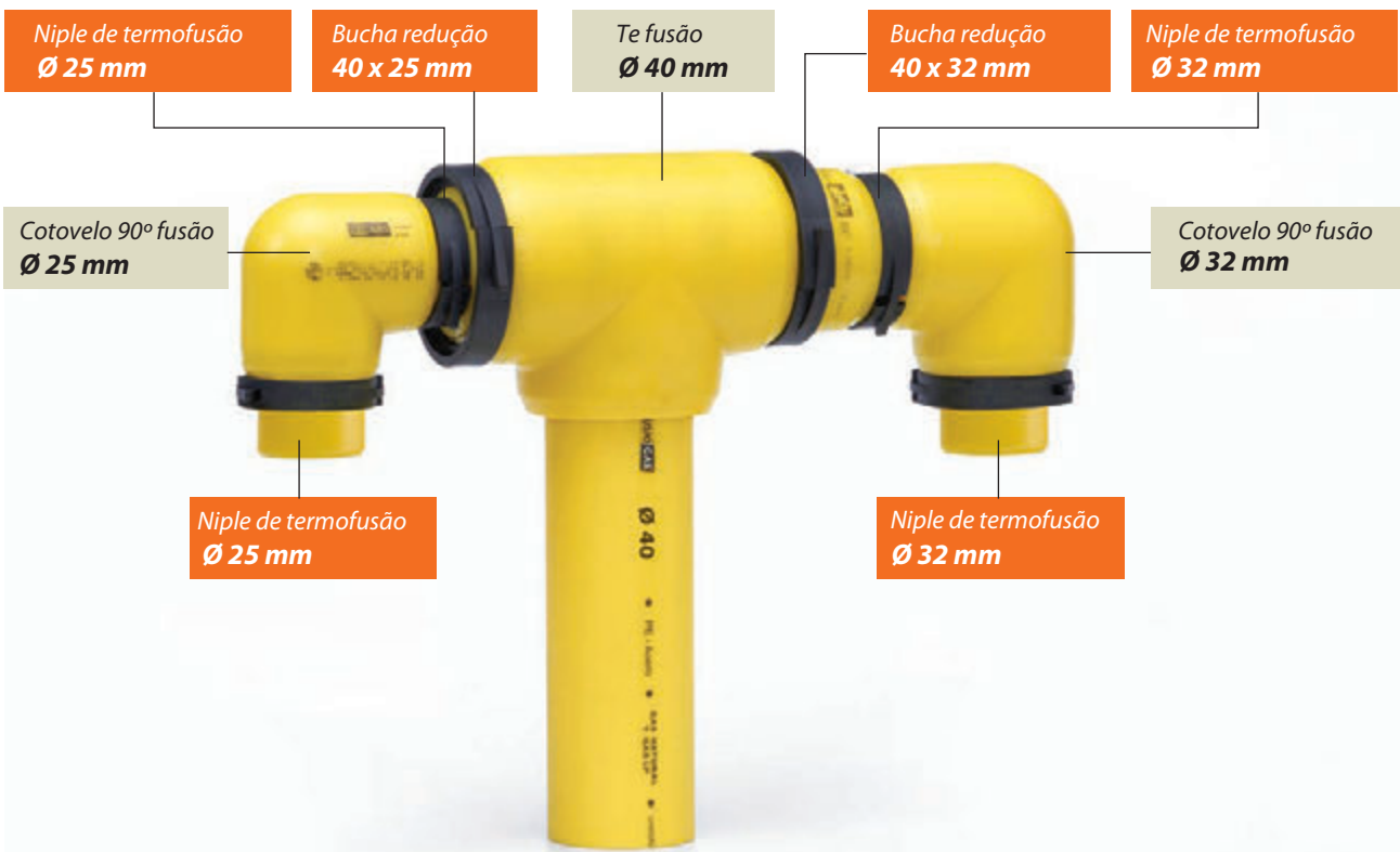
Redução de diâmetro e mudança de direção combinado com uma bucha de redução de 40 x 25 mm e um niple de termofusão de 25 mm
